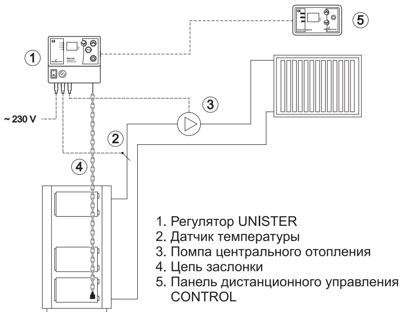
Рис. 1. Подключение регулятора к инсталляции центрального отопления
