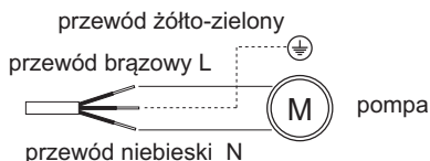
Rys. 4 Schemat podłączenia przewodu do pompy
